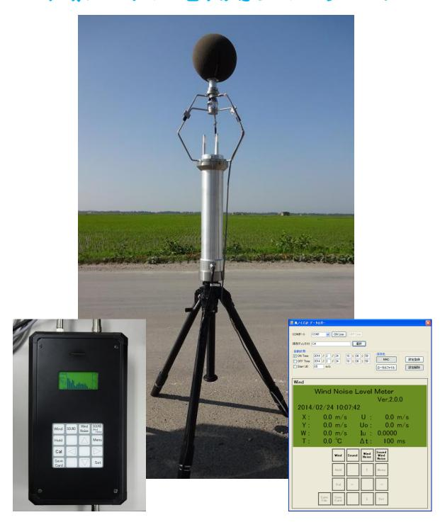
2 次元風速計を装備、風速をモニターしながら 低周波音を計測 超低周波音領域(20Hz 以下)の風ノイズを推計 特許取得済 特許第 5235120 号 特許取得済 特許第 6025148 号
